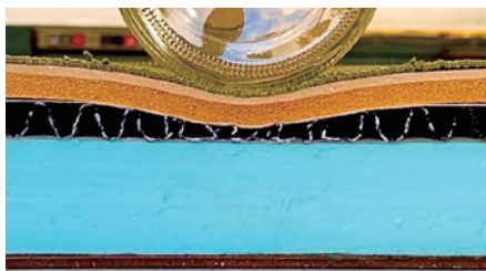
写真-1 緩衝材の荷重試験
