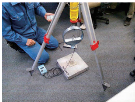
写真-2 転倒衝突時の硬さ試験
