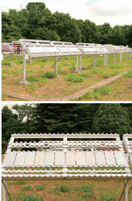
写真-2 国立研究開発法人建築研究所（つくば）での屋外暴露試験状況
