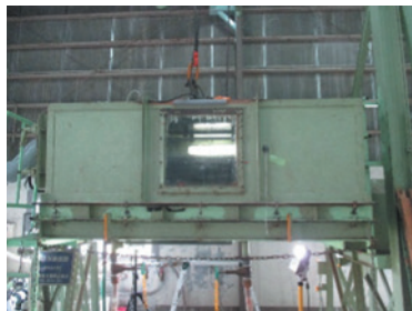
写真一3 防雨性能評価試験 （圧力箱方式）
