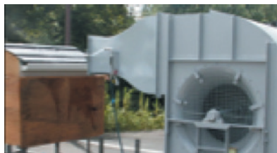
写真一2 防雨性能評価試験 （送風散水方式）
