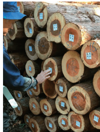
図-2 必要情報が確認できるQRコードを木材に貼付する様子
