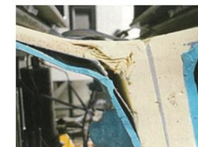
大阪ガスリノテックでは、経年使用されたFRPパネルを試験体として耐久性試験を実施している。引張試験（写真上）、曲げ試験（写真下）ともに、FRPパネル破断後もポリウレタ塗膜は破断されず、良好な結果が得られている。
