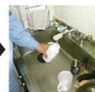
施工後の水質検査用採水
