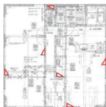
延べ床面積約35坪の建物での標準使用本数は6本。最大効果・最適配置となるように1棟ごとに配置設計を実施。
