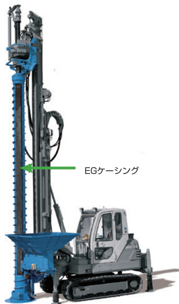
エコジオ地盤改良機
