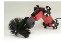
カシオペア型 ダクト清掃ロボット （特許出願中）
