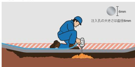
① 事前調査で床の沈下量や床下の空洞状況を確認。その後、6mmの小さな注入孔をあけてテラテック樹脂を注入する。
