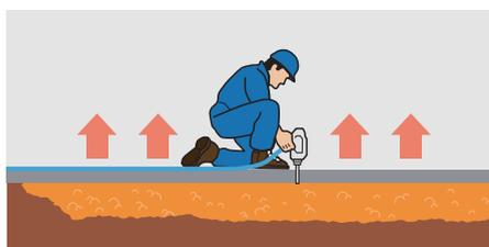
③ テラテック樹脂の膨張力で床を押し上げて、ミリ単位の精度で計測を行いながら沈下し傾いた床を水平にする。
