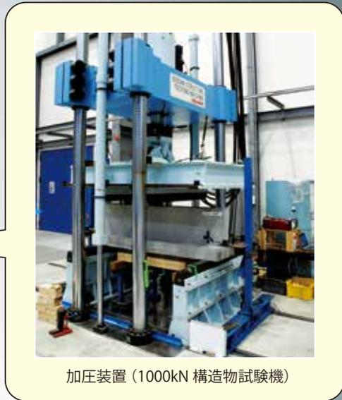
加圧装置 (1000kN 構造物試験機)
