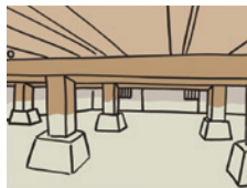
③施工完了（樹脂中の水分が完全に抜ければ完全硬化）
