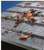
雪・台風にも強く、落ち葉が入らない雨とい。雨水を取り込むように設計された落ち葉除けの細かいスリットにより、樋の落ち葉詰まりを防ぐ。台風や積雪に強い耐久性を備え、積雪地域も使用可能。さまざまな軒先形状の既存屋根に取り付けられる。
