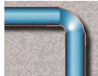
銀イオンを配合した抗菌塗料を高圧気流で塗布。管内にビグを往復させて均一な塗膜厚と滑らかな塗膜面を形成する。
