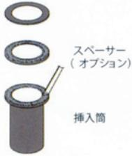
挿入筒の上部に指定接着剤を塗布して、トップカバーを取り付ける。スペーサー使用の場合は、間に挟んで取り付ける。
