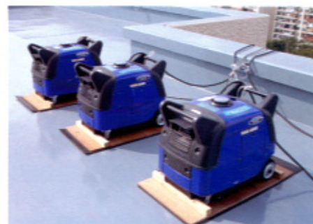
小型の発電機。電力はこれだけで施工可能。
