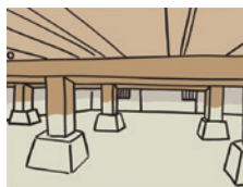
③施工完了 (樹脂中の水分が完全に抜ければ完全硬化)
