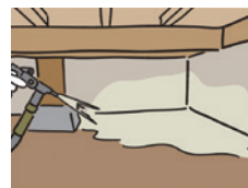
②床下点検口等からテクノガードを床下全面に散布
